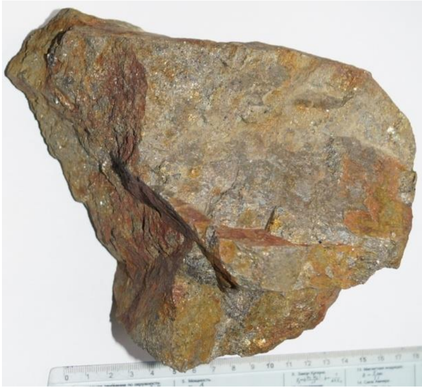
Рисунок 2.9 Образец сплошной пирротин-пентландитовой руды отобранной с Отвалов Аллареченского месторождения.
