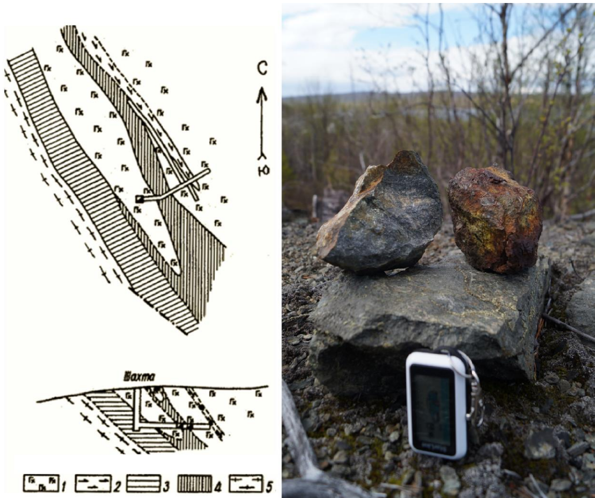
Рисунок 2.5 Схема геологического строения [78] (слева) и образцы рудной части месторождения Морошковое озеро (справа). 1 – нориты-габбронориты, 2 – крупнозернистое жильное габбро; 3 – лампрофир, 4 – актинолит-хлоритовые и кварц-хлоритовые сланцы; 5 – кварцевые диориты, диорито-гнейсы.
