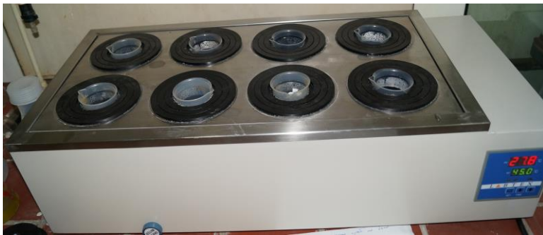
Рисунок 3.9 Водяная баня, проведение серии экспериментов попеременное увлажнение – высыхание с объектами ГПО и руды.
