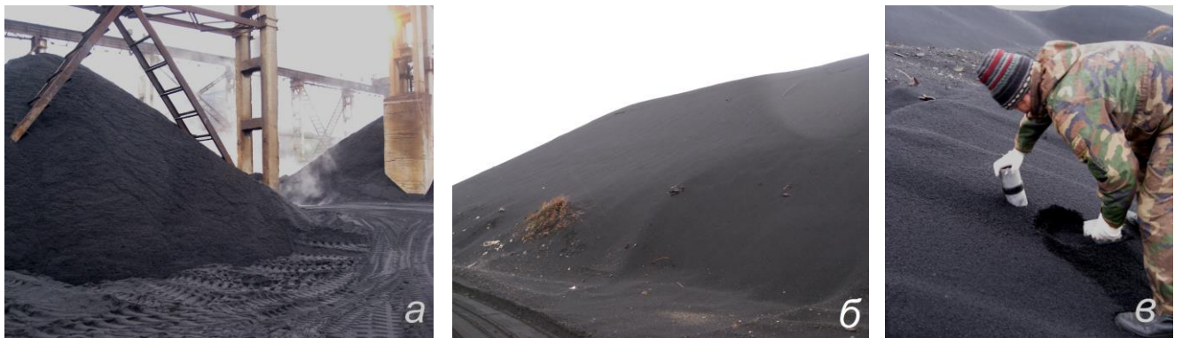
Рисунок 2.13 Гранулированные шлаки комбината «Печенганикель» текущего производства (а), отвал лежалых шлаков (б), отбор образцов шлаков с ненарушенной структурой (в)
